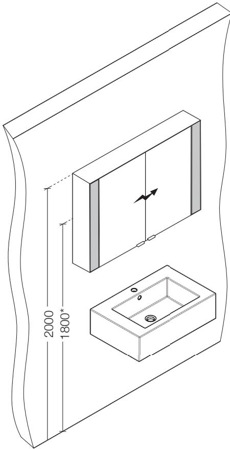
\* (Kabel/Stromanschluß, mittig Spiegelschrank / Höhe 1800)
