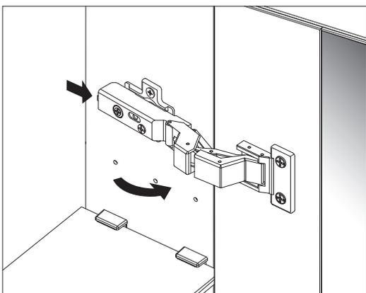
2. Ziehen Sie mit dem Finger an dem Hebel. KLICK. Das Scharnier ist entrastet.
