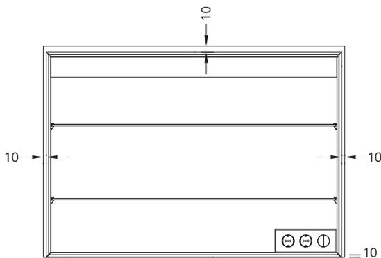
Der Mindestabstand von 10-12 mm wird benötigt, um den Schrank in die Schienen einhängen zu können.
