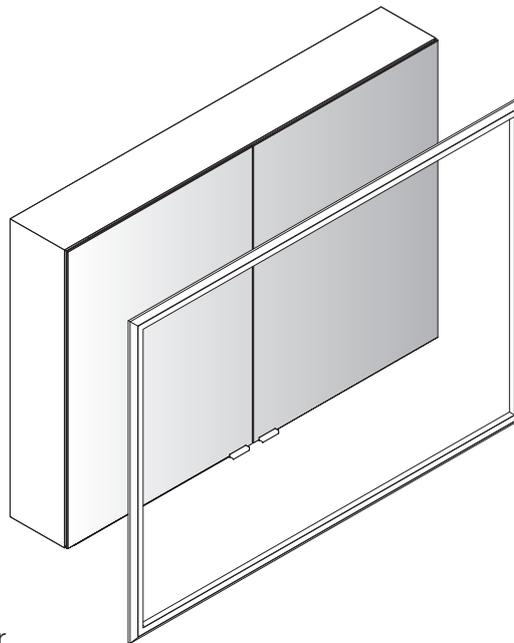
➔ Verbinden Sie vor jeder endgültigen Montage den LED-Abdeckrahmen mit dem Verbindungskabel.
