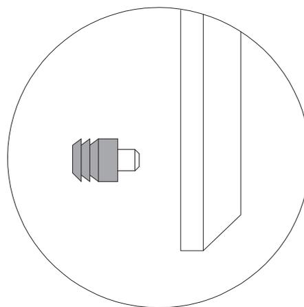
➔ Bevor Sie den Rahmen montieren können, entnehmen Sie die Verbindungsdübel!
